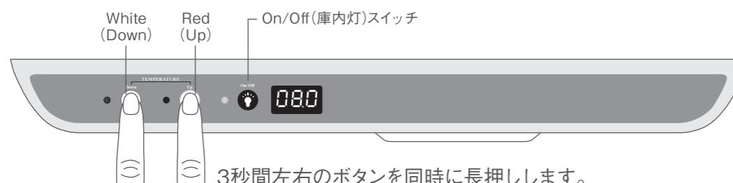
設定温度表示は[1.0]°C刻み、庫内温度表示は[0.5]°C刻みとなります。なお8°C時、13°C時にはそれぞれ「White」「Red」のLED表示ランプが点灯します。
